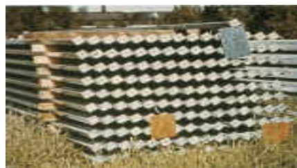
Fig. 3: Almacenamiento incorrecto. Aunque se han colocado separadores de madera entre los diferentes perfiles del paquete, éstos han sido situados con su parte cóncava hacia arriba, por lo que acumularán agua de lluvia y humedad. Por otra parte, los paquetes descansan directamente sobre la hierba húmeda.
